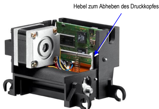
Abb. 5 Friktion zwischen Druckkopf und Druckwalze aufheben
