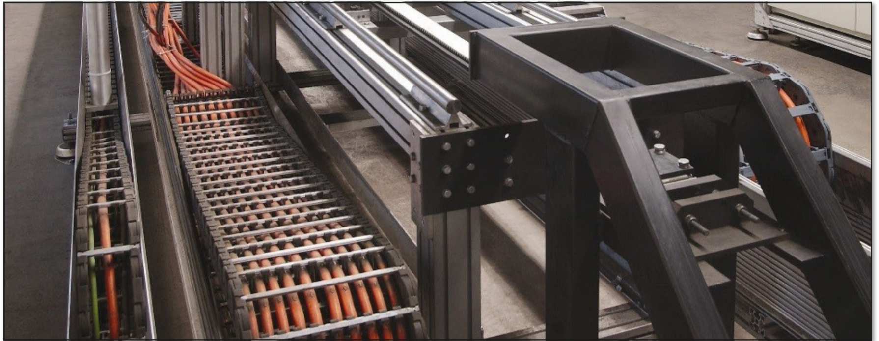
Schleppkettentestanlagen im Helukabel Forschungs- und Entwicklungszentrum.
